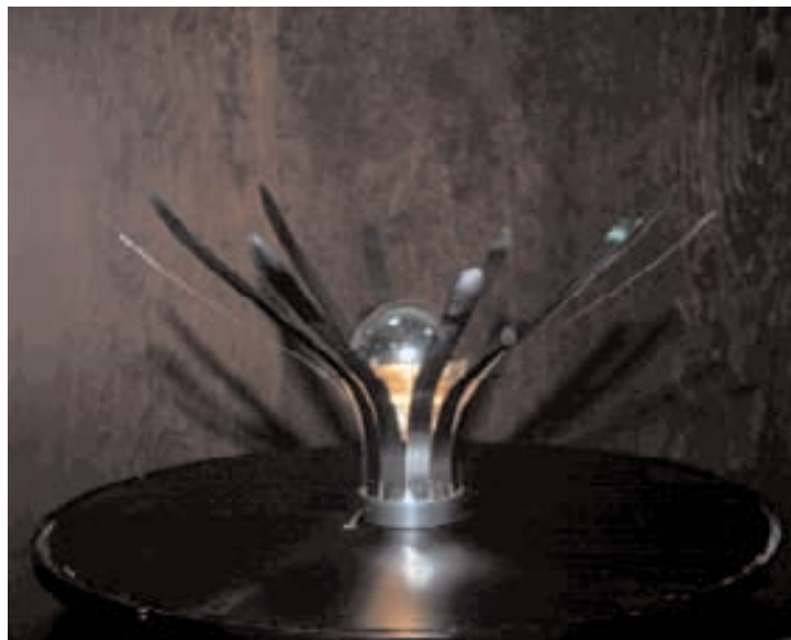
Flor de metal. Se trata de un objeto diseñado por un artista, en forma de flor con pétalos, compuestos cada uno por dos láminas pegadas de metales diferentes. El calor de una lámpara es suficiente para que los pétalos bimetálicos se deformen y la flor se abra. Al abrirse, las láminas se alejan del foco y se enfrían, por lo que regresan a su forma inicial y la flor se cierra. El fenómeno puede continuar indefinidamente.
