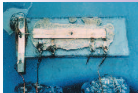
Figura 6. Primer circuito integrado. En 1958, Jack Kilby inventó el primer circuito integrado trabajando en Texas Instruments. Constaba de un solo transistor y otros componentes en una rebanada de germanio de aproximadamente 11 por 1.6 milímetros. El circuito integrado revolucionó la industria electrónica: casi cualquier dispositivo electrónico existente hoy en día tiene sus raíces en Dallas, hace casi 50 años (cortesía de Texas Instruments).
