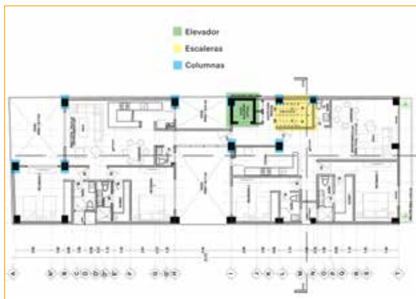
Figura 4. El plano estructural de un edificio muestra la ubicación de las columnas (rectángulos negros-azules); se observa que la zona con mayor concentración de columnas es donde se ubican las escaleras y los elevadores.
