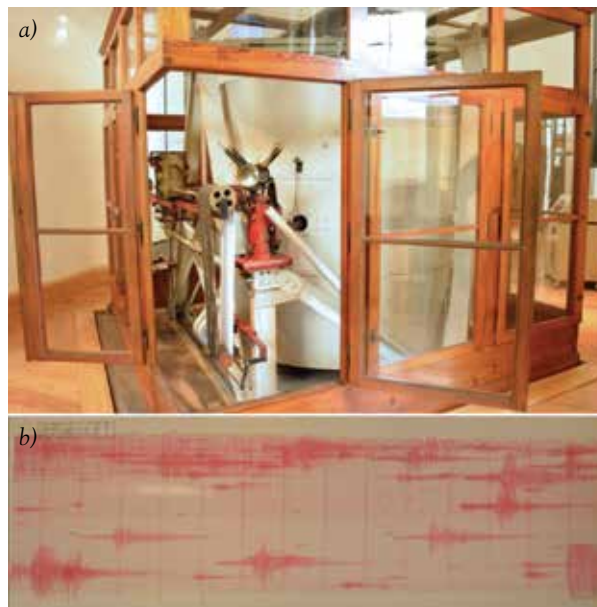
Figura 3. a) Sismógrafo horizontal Wiechert; el gran cilindro blanco es una masa de 17 toneladas suspendida por tres puntos. Éste se encuentra en exhibición en el Museo de Geofísica de la UNAM. b) Registro del 19 de septiembre de 1985 en la estación de Pinotepa Nacional, Oaxaca. Hasta arriba se aprecia el registro del sismo de magnitud 8.1 de esa mañana, cuyo epicentro fue en las costas de Michoacán.
