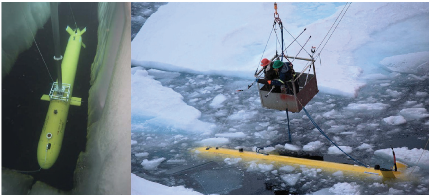
Figura 5. Izquierda: lanzamiento del vehículo autónomo autopropulsado Explorer para una misión de cartografía, a partir de un campamento de hielo, cerca de la isla Borden en el alto Ártico canadiense. Fuente: Don Glencross, DRDC-Atlantic. Derecha: recuperación de un vehículo autónomo submarino autopropulsado por el buque CCGS Louis, St-Laurent en el área de Sever Spur, en la cuenca Ártica canadiense. Fuente: Fisheries and Oceans Canada.
