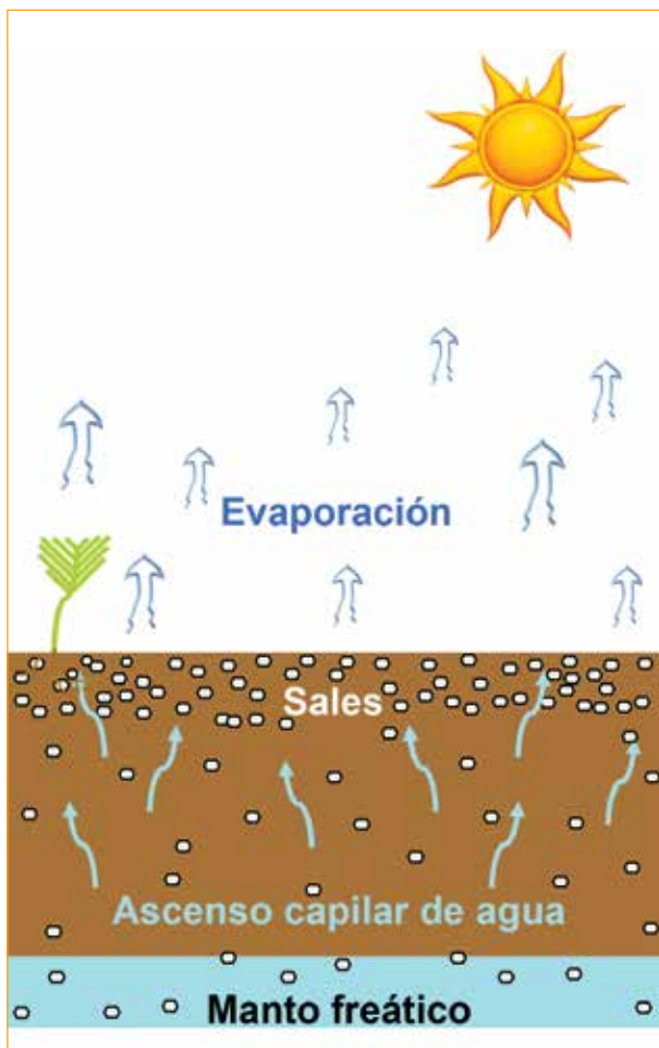
Figura 1. Ascenso capilar de agua desde un manto freático de poca profundidad (< 2 m). Se observa el proceso de salinización en la superficie del suelo después de que el agua se ha evaporado.
